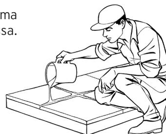
**H** Aplicar às 24/48 horas massa fina de cimento branco, (BL V 22,5 UNE 80305 96). Para preencher as juntas entre as tijoleiras e utilizar cimentos de rejuntar de conformidade com a norma UNE EN 13888. Existem no mercado cimentos de rejuntar coloridos que podem ser utilizados para essa finalidade.
